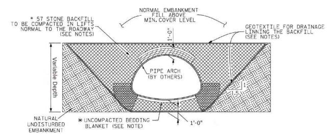
CRITICAL BACKFILL ZONE, PRESSURE ON SOIL GREATEST HERE.
